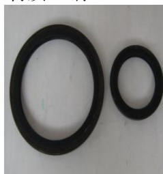
曲轴后油封: 1个/台 材质: SI 95*118*10 曲轴前油封: 1个/台 材质: SI 50*68*9
