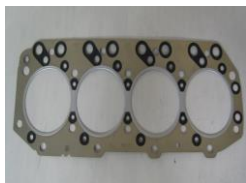
汽缸垫: 1片/台 材质: 金属
